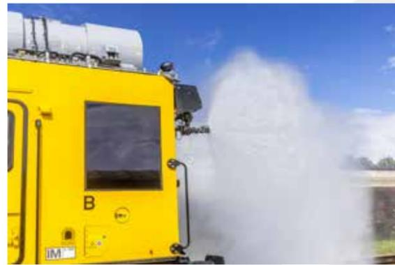
Ob Voll- oder Sprühstrahl: Mit bis zu 100 bar donnert das Löschmittel auf das Brandobjekt.
