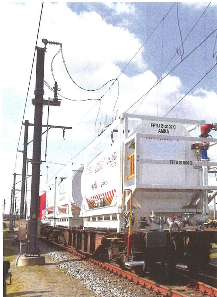
Tankcontainer und der Löschcontainer montiert wurden. Die Position der Lokomotive in der Mitte dient der Distanzierung in Bezug auf Wärmekonturen. Die Tankcontainer, einer davon mit 26.000 Litern und vier mit 31.000 Litern Wasser, waren über ein 250 mm Rohrleitungssystem mit flexiblen Verbindungen zwischen den drei Waggons und der Lokomotive mit der Feuerlöschleinheit verbunden. Knapp zwei Monate nach der Engineering-Phase entstand eine „Höllens-Feuerlöschmaschine“.
