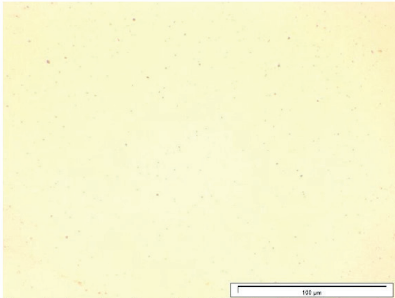
Figuur 5. Dwarsdoorsnede over de draad. De oxideverdeling in de kern van de draad.
