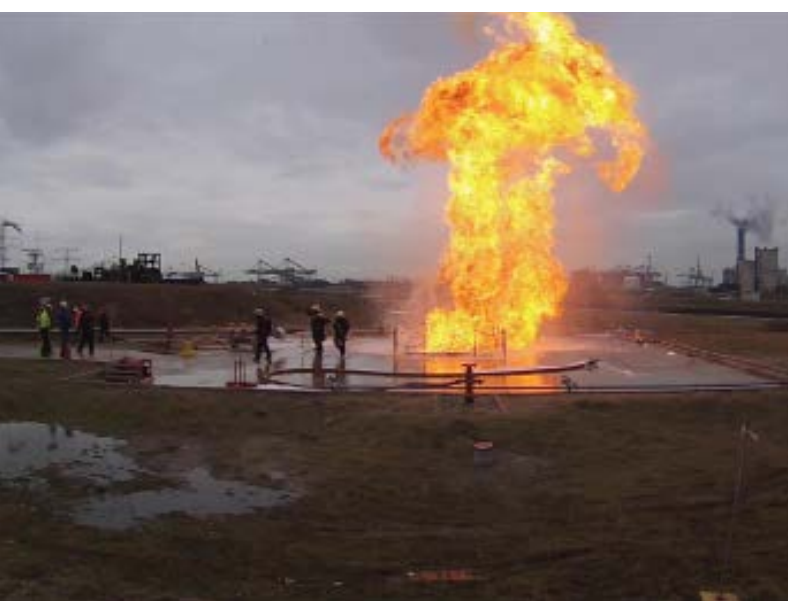
IJsexplosie als gevolg van de schuimblussing van een relatief kleine (bio-)LNG-plasbrand.
